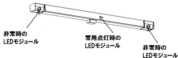
解説図1-非常時のLEDモジュールの点灯の数（2のものの例）
